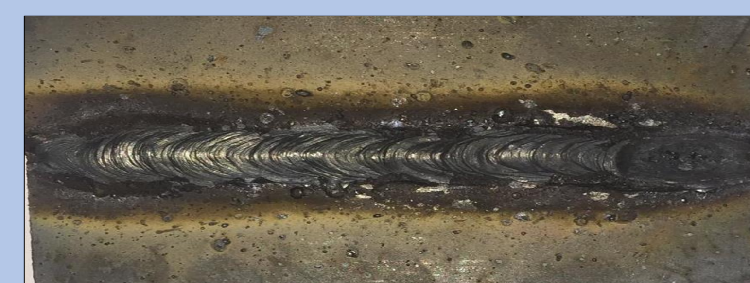
Figura 3. Resultado de la prueba de acero con SMAW
