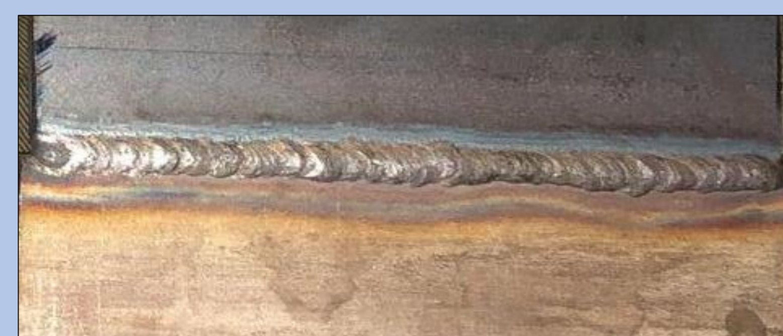
Figura 1. Resultado de la prueba mixta con TIG
