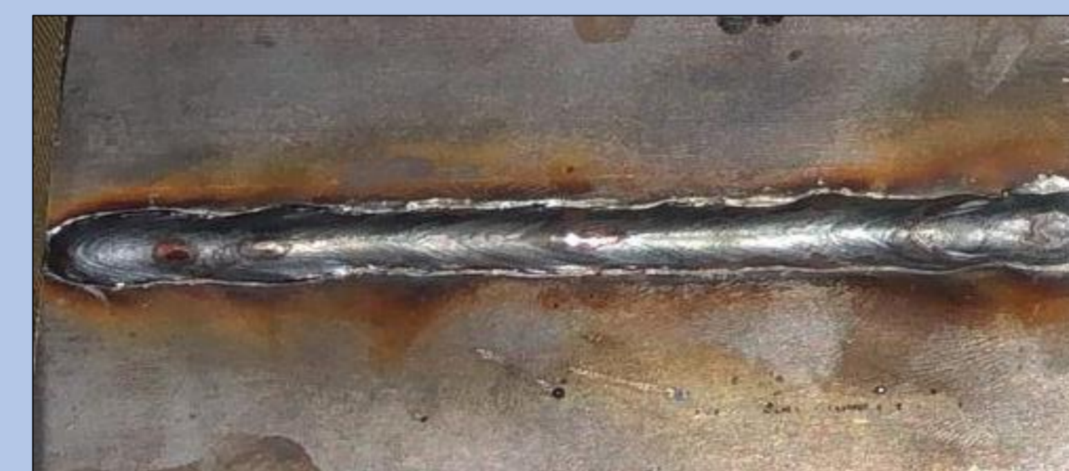
Figura 2. Resultado de la soldadura de acero con MAG
