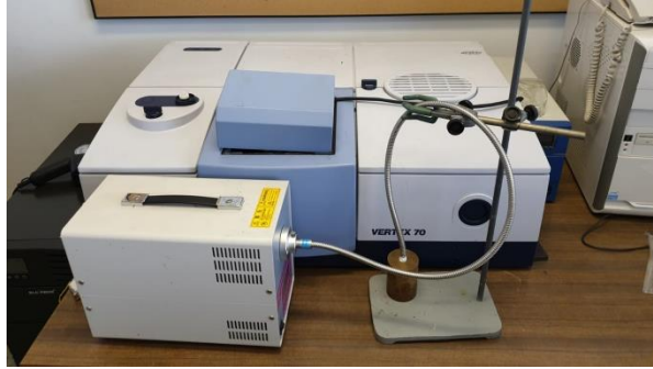
Figura18. Espectòmetre Bruker Vertex70
