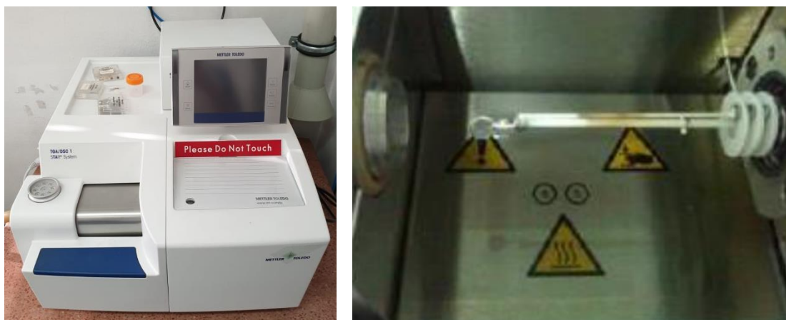
Figura 17. TGA/SDTA 851e i detall de l'interior del forn de la termobalança
