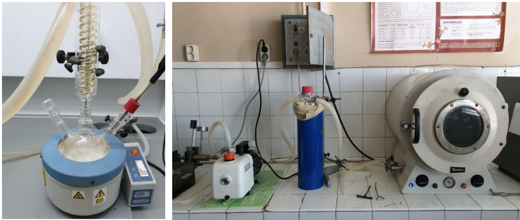
Figura22. (a) Sistema de escalfat i condensat del diclorometà amb la mostra de solut. (b): Forn amb bomba de buit
