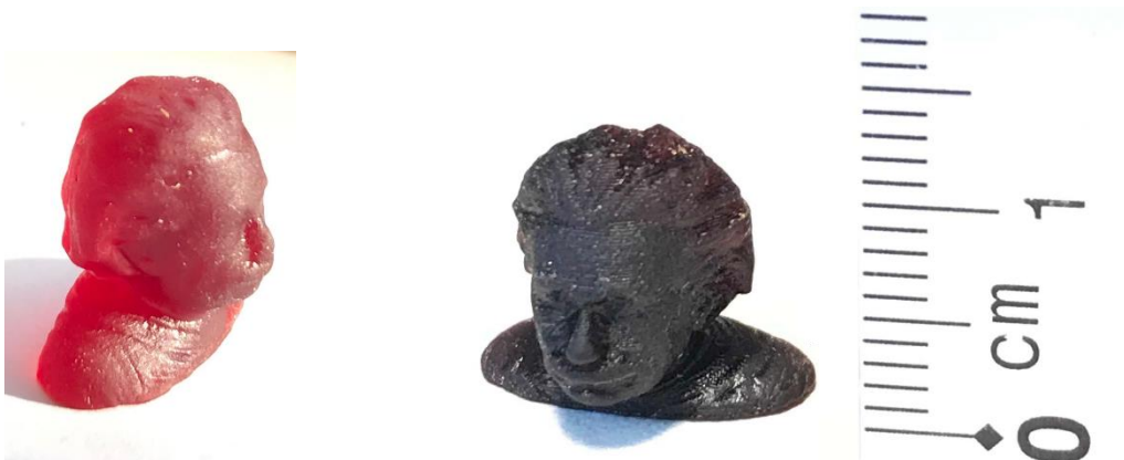
Figura 28. Bust del Dr. Einstein imprès amb la formulació HT50CEMA50_R0,25_DMAP0,025. Bust de l'esquerra després de la primera etapa (impressora) i el de la dreta després de la segona etapa (forn).
