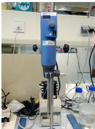
Figura 0.4. Agitador Ultra Turrax T18, IKA
