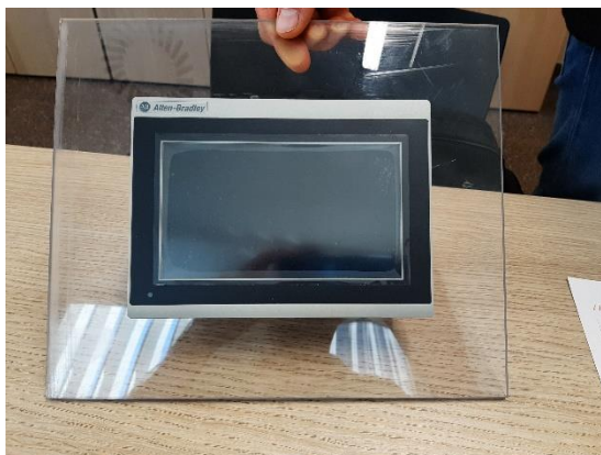
Figura 2.45. Inserción del terminal gráfico en el panel de policarbonato (Fuente: propia)
