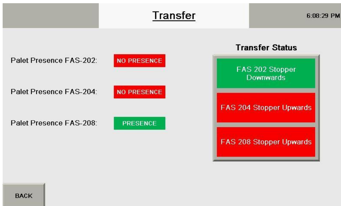
Figura A.10. Pantalla Transfer (Fuente: propia)
