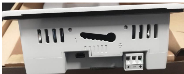
Figura 2.46. Detalle del conector de alimentación del PV800 (Fuente: propia)
