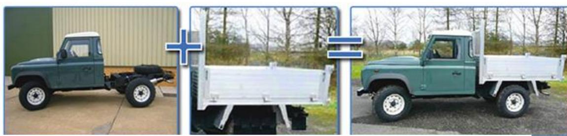
**Figura 3.1.2.1.** Vehículo 1ª fase + Vehículo 2ª fase = vehículo completado. (Fuente: Automovilidad)
