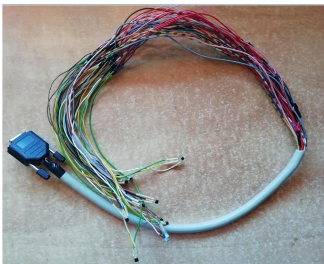
Figura 7.5. Mànega del cablejat dels sensors.
