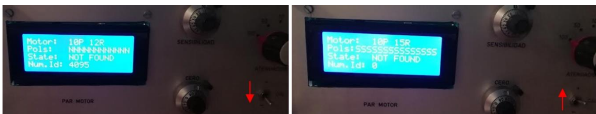
Figura 7.8. Canvi del programa de l'estator de 12 ranures al de 15 ranures.
