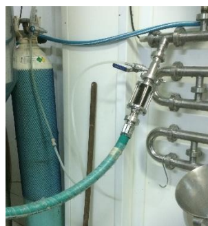
Figura 10. Injecció l'oxigen pur en el most refredat. Font pròpia
