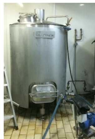
Figura 8. Olla de cocció amb tapa a la part superior per afegir el llúpul, i una comporta a la part inferior per treure el hot trub i restes de llúpul. La bomba s'utilitza per transportar el most i realitzar el remolí per acumular els sòlids al centre del tanc. Font pròpia.
