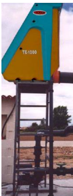
Figura 30. Estructura per elevar el tamís. Font: www.toroequipment.com
