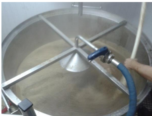
Figura 7. Interior del tanc macerador amb ruixador per fer el sparging. Font pròpia.
