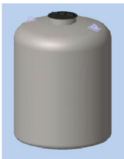
Figura 31. Dipòsit per ser enterrat de fibra de vidre. Font: www.tadipol.com
