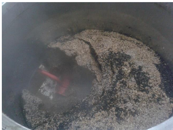
Figura 13. Extracció del bagàs del tanc de maceració posterior al sparging. Font pròpia
