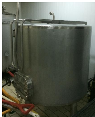
Figura 6. Tanc macerador amb una comporta a la part inferior per extreure el bagàs. Font pròpia.
