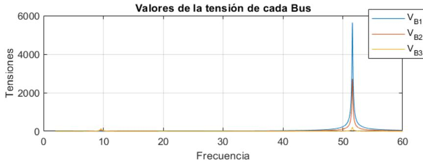
Figura 24. Voltajes que aparecen en cada Bus inyectando en nudo 1
