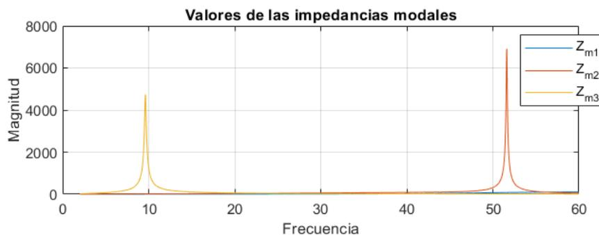
Figura 26. Resonancias del sistema. Modo y frecuencia.
