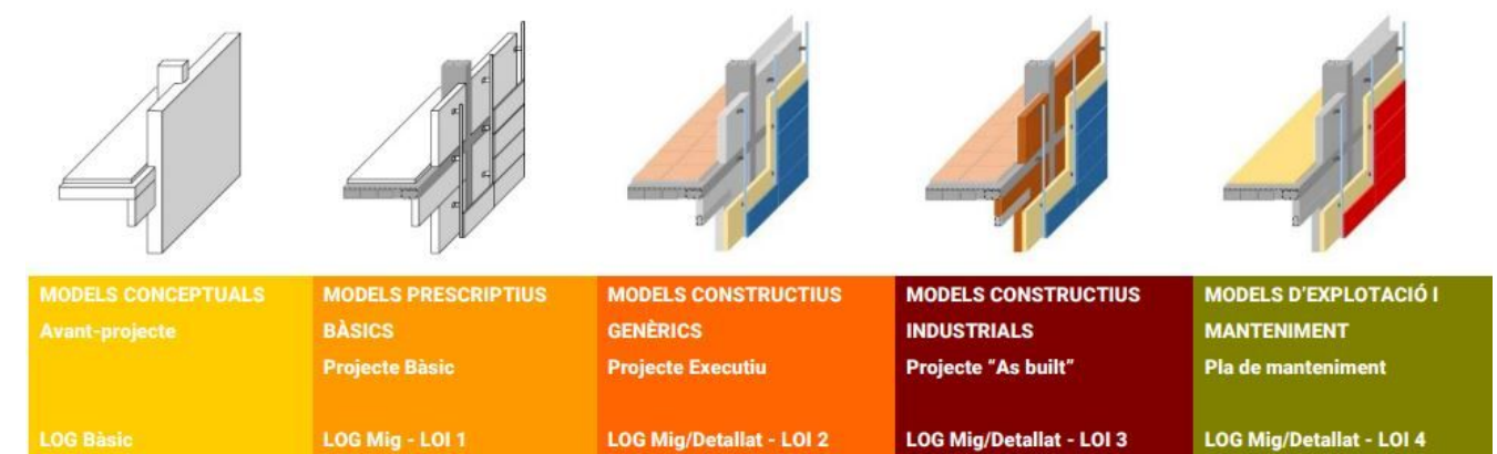
Figura 3.3.5: Desenvolupament gradual dels objectes BIM segons els nivells de definició de l'objecte. Captura extreta de l'Estàndard de creació d'objectes "eCOB".
