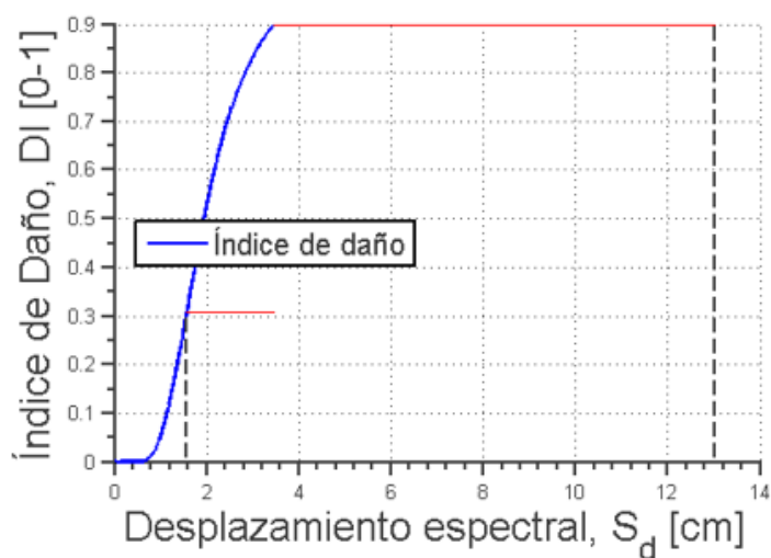
Figura 111: Índex de dany X-Push per cada desplaçament espectral del ED02 segons NCSE-02 1
