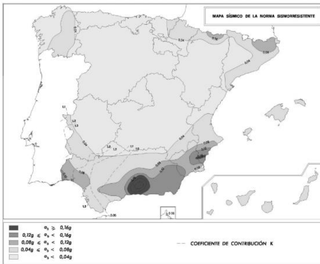
Figura 26: Mapa de perillositat sísmica on s'aprecia el PGA i K^2
