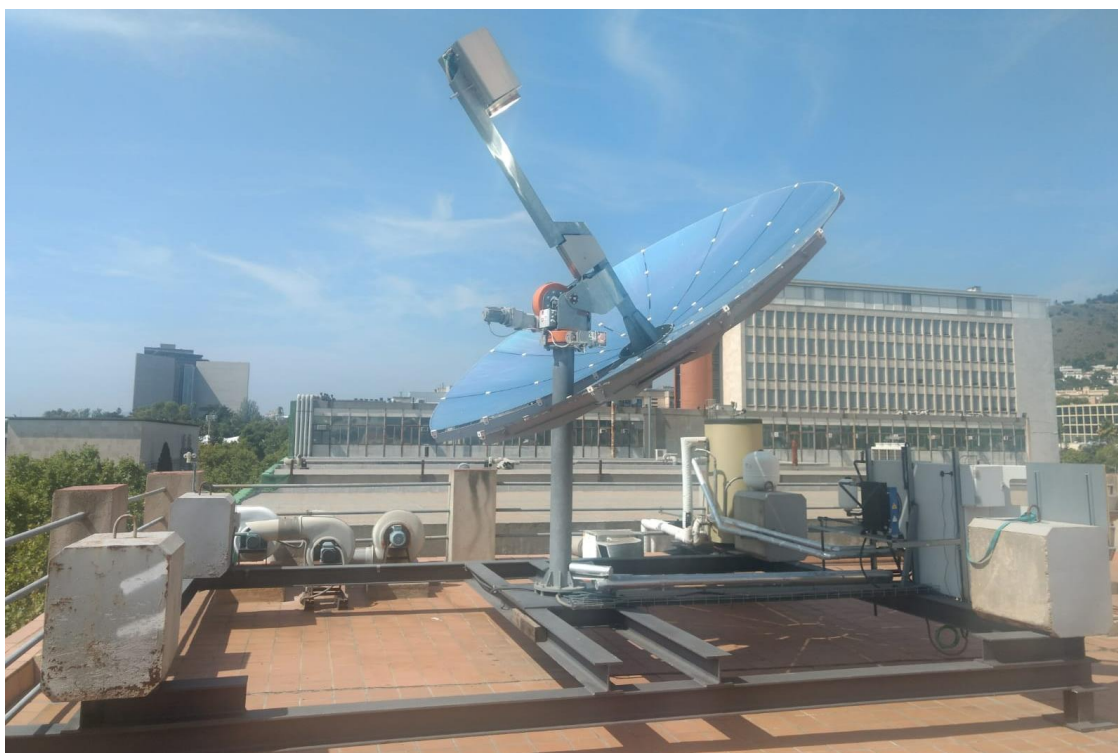
Figura 3.2. Sistema dish Stirling del terrat del pavelló C de l'ETSEIB [font pròpia]
