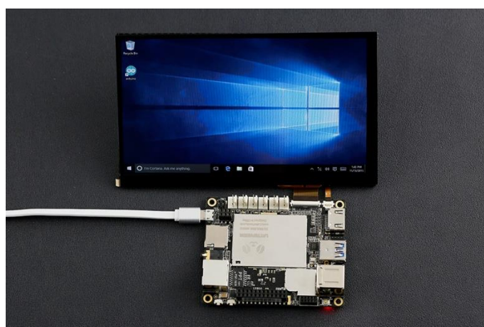
Figura 1. Placa de desarrollo Lattepanda (LattePanda, 2019)
