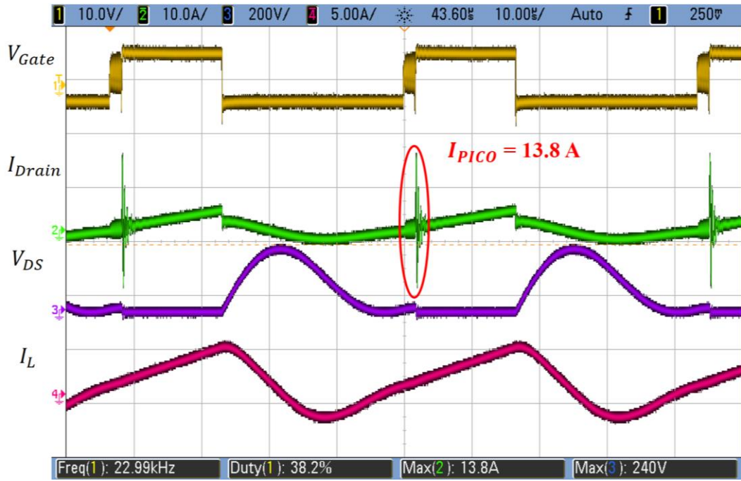
Figura 56. 1SW-ZVS con 70 V, 47nF, D=55%, P=45. Con modulación.
