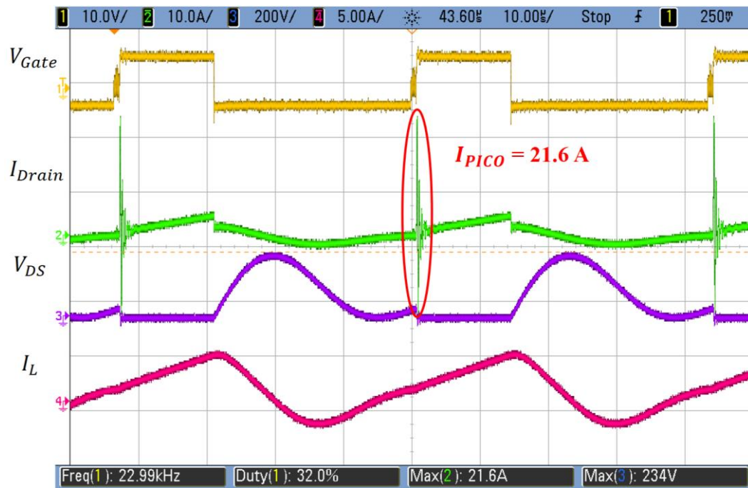
Figura 54. 1SW-ZVS con 70 V, 47nF, D=50%, P=20. Con modulación.
