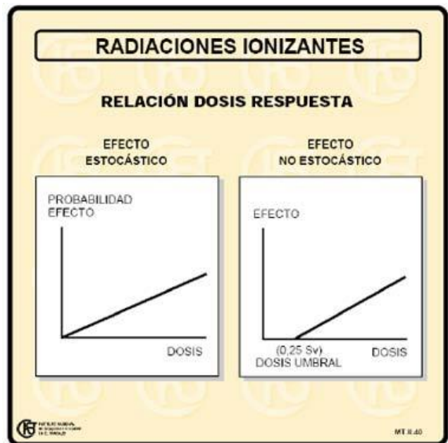
Fig. 3.9: Relación entre la dosis y la respuesta de los efectos de las radiaciones ionizantes.
