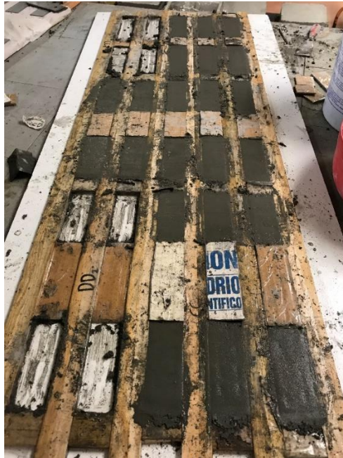
Figura 28. Procés d'allisat superficial de les provetes al motlle
