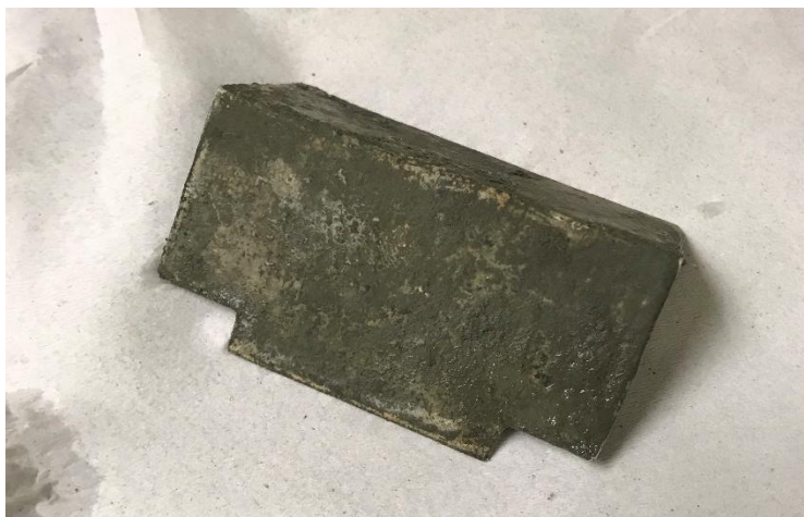
Figura 26. Estri utilitzat en la distribució del morter al llarg del motlle
