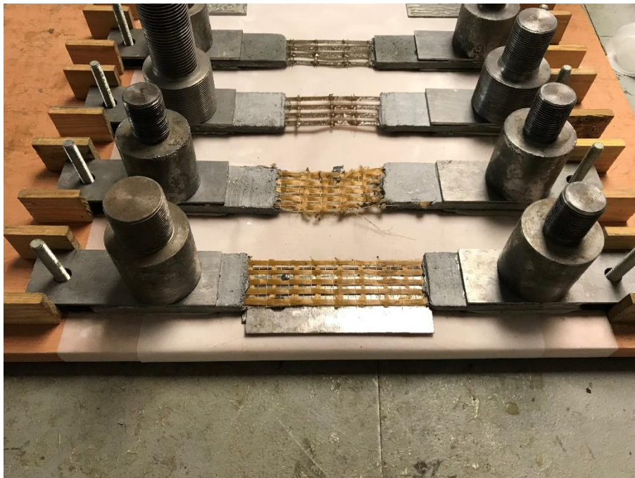
Figura 34. Exemple de provetes en el procés d'adhesió de la platina amb l'ús de pesos
