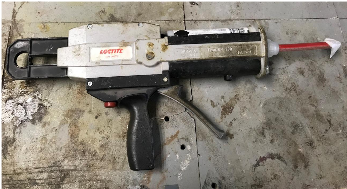
Figura 31. Pistola utilitzada en l'aplicació del adhesiu epoxi
