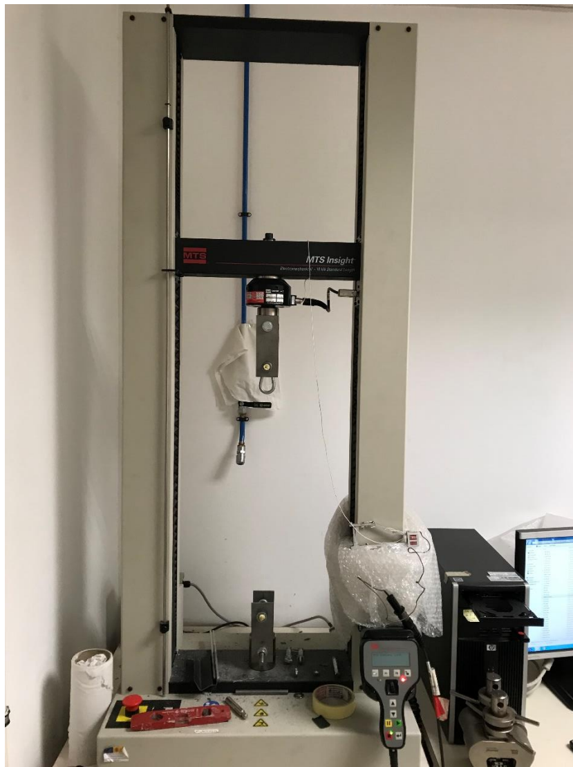
Figura 36. Premsa utilitzada Insight 10 kN de la marca MTS
