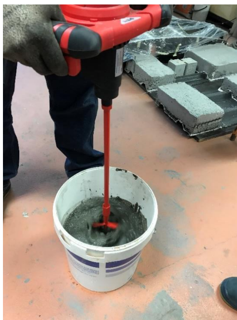
Figura 24. Mescla del morter amb la màquina mescladora
