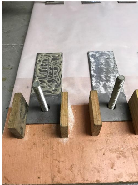
Figura 33. Exemple d'aplicació de l'adhesiu a la platina
