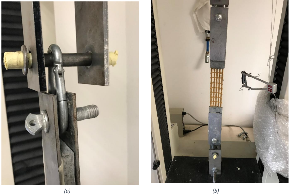
Figura 39. (a) Mètode d'ancoratge de la proveta a la premsa, (b) Proveta ja muntada
