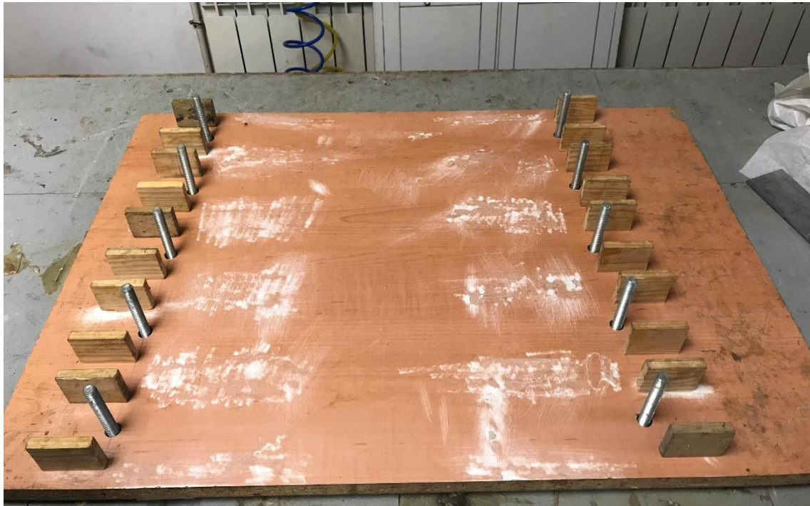
Figura 32. Motlle d'adhesió de les platines a la superfície de les provetes
