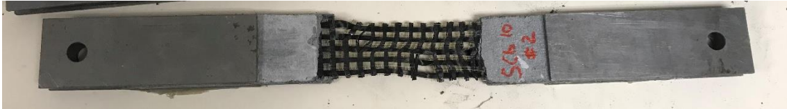
Figura 109. Fotografia ruptura proveta SCb10_2
