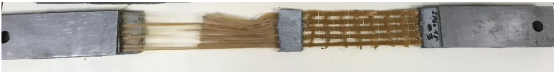
Figura 171. Fotografia ruptura proveta SPbo15_3
