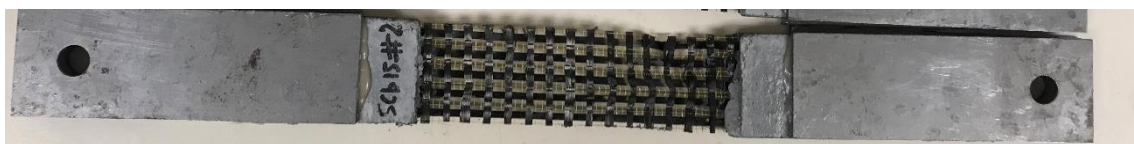
Figura 123. Fotografia ruptura proveta SCb15_2
