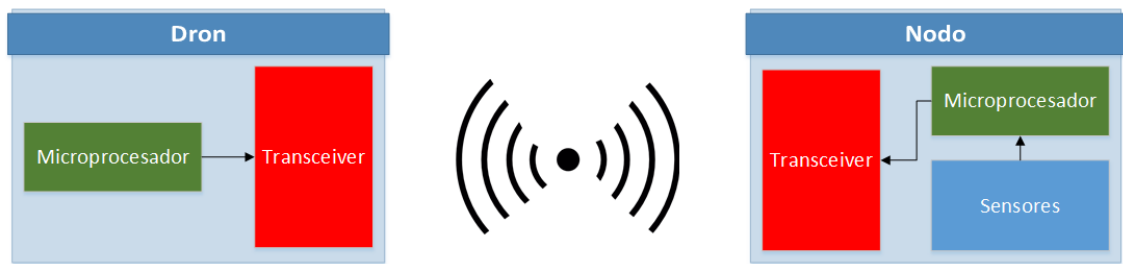
Figura 2.1: Esquema sistema monitorización Dron-Nodo
