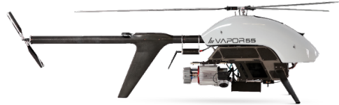
Figura 6.2: Ejemplo dron con rotor principal y rotor antipar [4]
