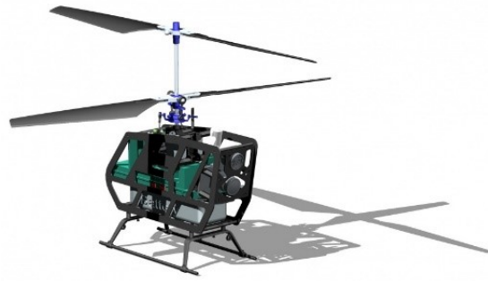
Figura 6.4: Ejemplo dron con dos rotores coaxiales [5]
