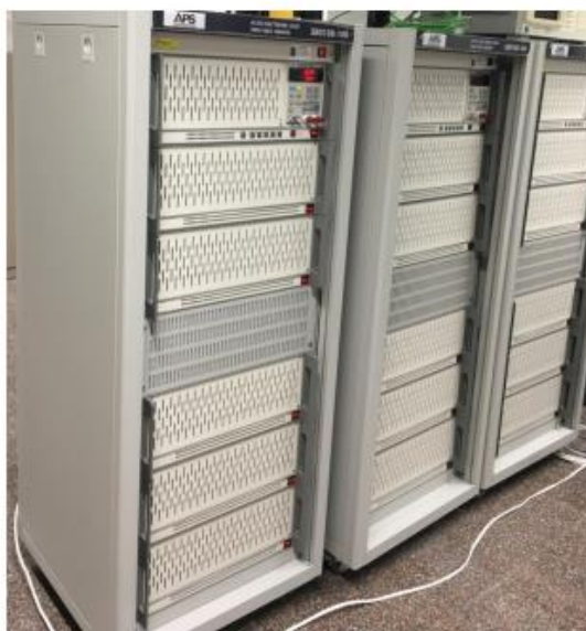
Figura 3.9. Càrregues electròniques programables APS 3B Series AC. Model 3B108-108 (Aleix Garcia, 2018)
