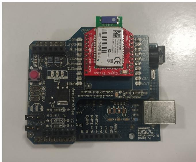
Figura 3.11: Placa Arduino Uno adaptada al módulo RN41XVC-I/RM
