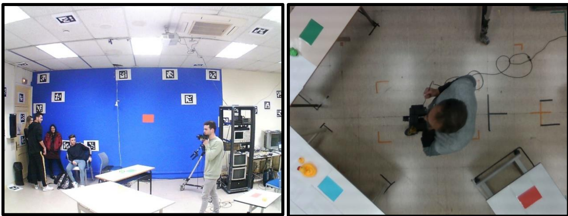
Fig. 11: Disposición del Plató del TR1 durante la época de toma de capturas. En la imagen de la izquierda se aprecia la cámara cenital [7] en el techo, y la estructura de cámara + sensor de inercia, en la barbilla del sujeto. En la derecha se aprecia la imagen captada por [7] en ese momento.
