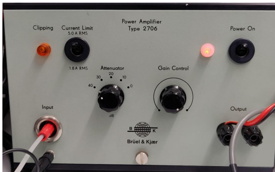
Il·lustració 11: amplificador de potència per alimentar l'altaveu
