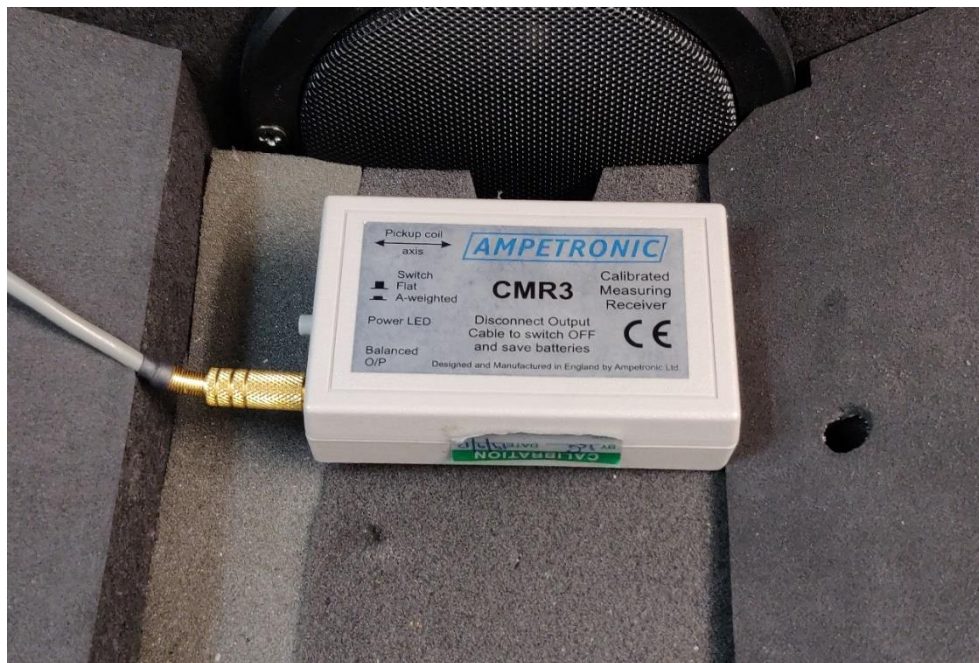
Il·lustració 22: mesurador de bucle inductiu CMR3 posicionat per l'equalització
