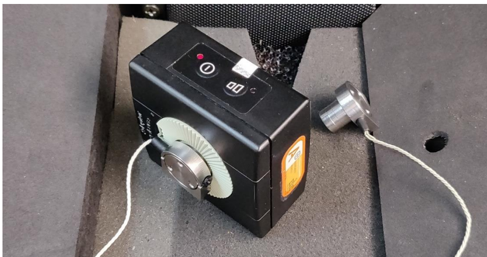
Il·lustració 21: micròfon connectat al pistòfon per al calibratge
