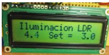
Figura 53. Visualización del LDR en protoboard
