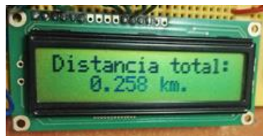
Figura 57. Visualización de la distancia en protoboard
