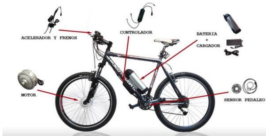
Figura 8. Componentes bicicleta eléctrica (Fuente: www.medioambienteynaturaleza.com )
