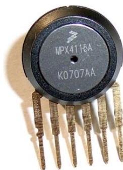
Figura 24. Sensor de presión y altímetro digital MPX4115 (Fuente: www.rs-online.com )
