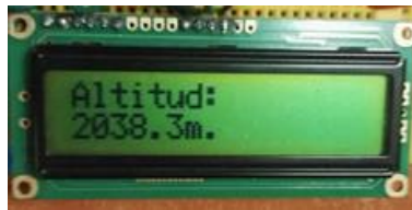
Figura 59. Visualización de la altitud en protoboard
