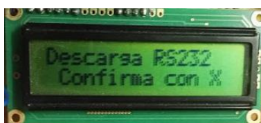
Figura 64. Visualización LCD en protoboard
