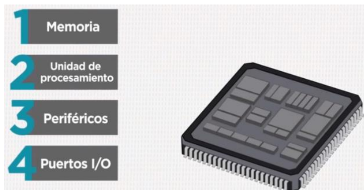
Figura 16. Partes principales de un microcontrolador (Fuente: www.youtube.com)
