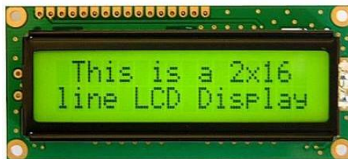
Figura 27. LCD 2x16 (Fuente: www.programarpicenc.com )
