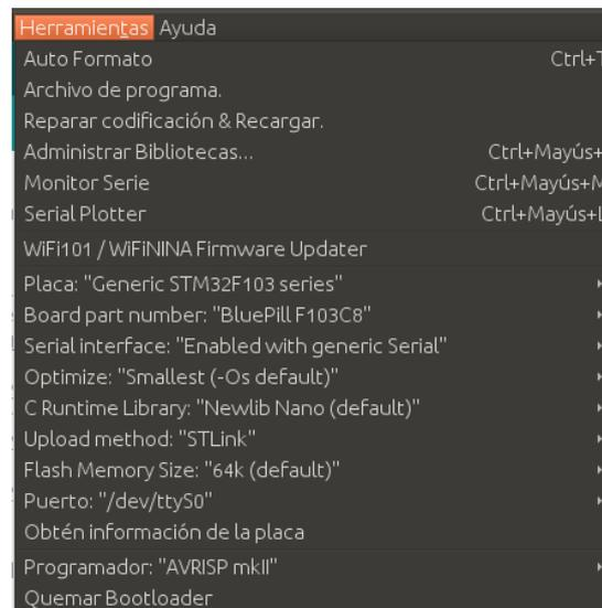
Figura 23. Desplegable de herramienta de Arduino
