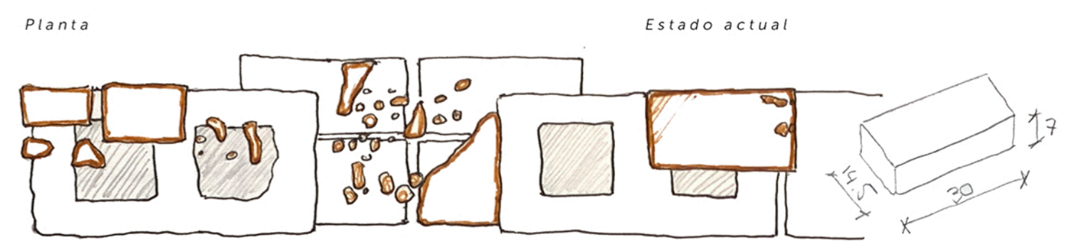
Detalle 2. Relleno de huecos por falta de vigas en pilares
