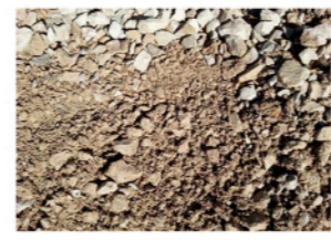
5 Capas de sustrato arcilloso en este caso zahorra reciclada, compactadas en el curso de los trabajos hasta el 85-90% UNE-EN 13242 Áridos para bases
