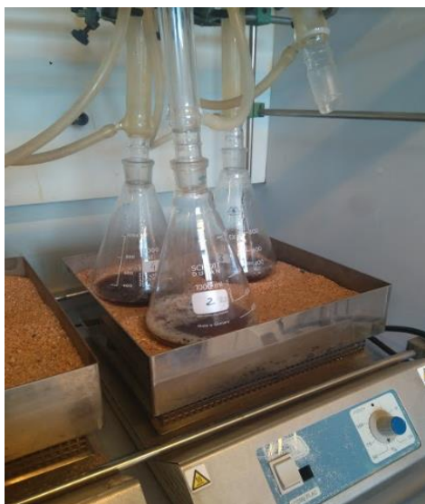
Figura 10 Reflujo de las muestras del método Van Soest
