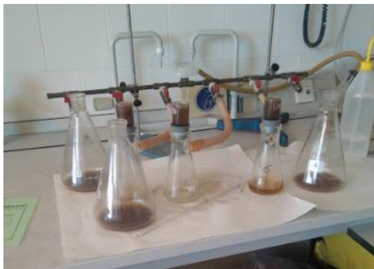
Figura 9 Aspiración al vacío para la filtración de la última hidrólisis del método Van Soest
