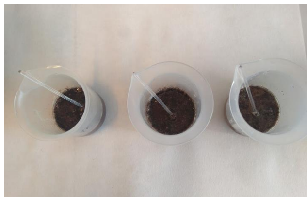
Figura 6 Primera hidrólisis del método Klanson
