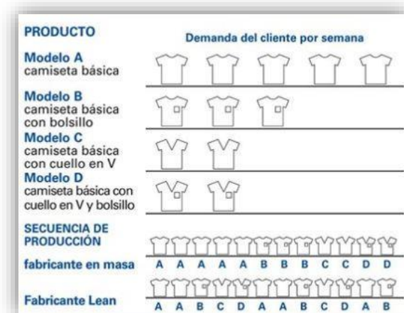
Ilustración 16: Nivelación mix (Material propio)
