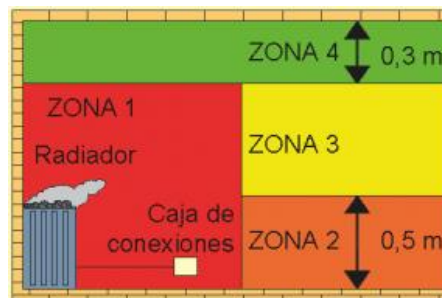
Figura 5.9.-Identificación de los volúmenes de instalación en saunas. Extracto de la ITC-BT-50 .
