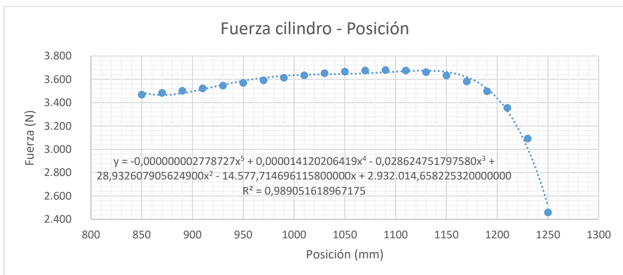
Fig. 7: Curva de fuerzas en función de la posición para carga 0 kg
