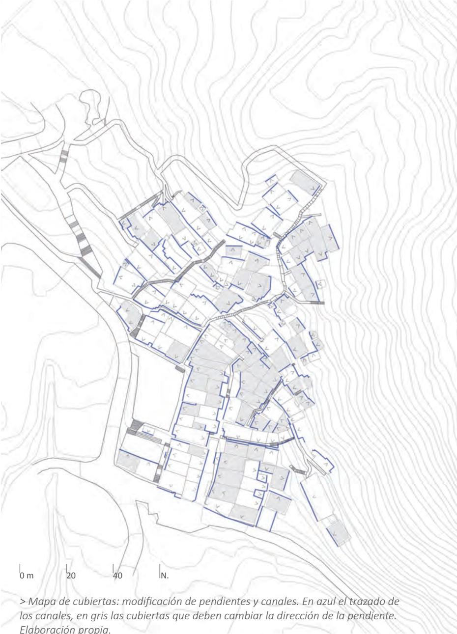
> Mapa de cubiertas: modificación de pendientes y canales. En azul el trazado de los canales, en gris las cubiertas que deben cambiar la dirección de la pendiente. Elaboración propia.
