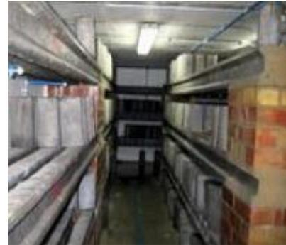
Ilustración 3-11 Cámara de curado
