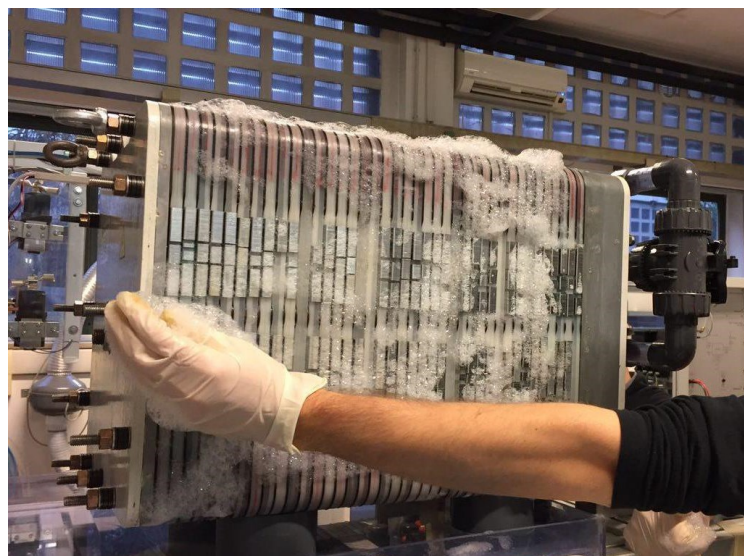
Figura 6-13. Test di tenuta realizzato tramite l'utilizzo di azoto a 0,5 bar
