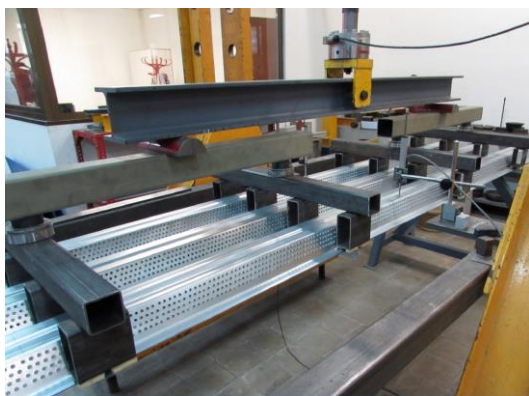
Fig. 4.13. Sistema de càrrega i posició dels captadors de desplaçament en el assaig d'un sol va.
