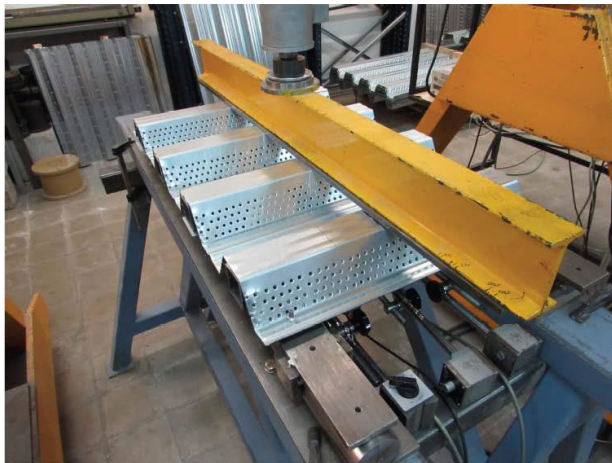
Fig. 4.14. Sistema de càrrega i posició dels captadors de desplaçament en el assaig de suport intermedi.
