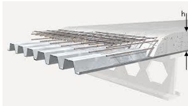
Fig. 3.1. Components d'un forjat col·laborant.
