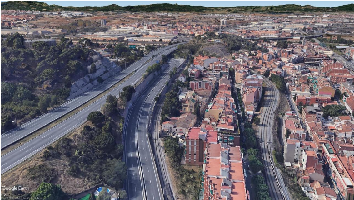
Figura 3.4. Línia Barcelona - Vic al seu pas per Montcada. D'esquerra a dreta: C-33, C-17, línia Barcelona - Vic, habitatges i línia Barcelona - Manresa. S'observa com la línia de Vic va enganxada al mur de la C-17. Dades de la imatge: Google Earth, Landsat / Copernicus, Institut Cartogràfic de Catalunya
