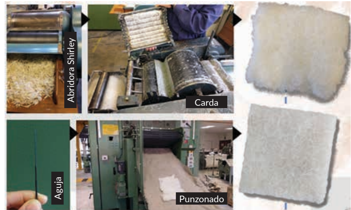
Figura 2. Etapas de la fabricación de un material absorbente acústico no-tejido con plumas y lana 50/50 %
