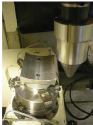
Figura 3. Herramienta de bruñido actuando en una probeta cóncava
