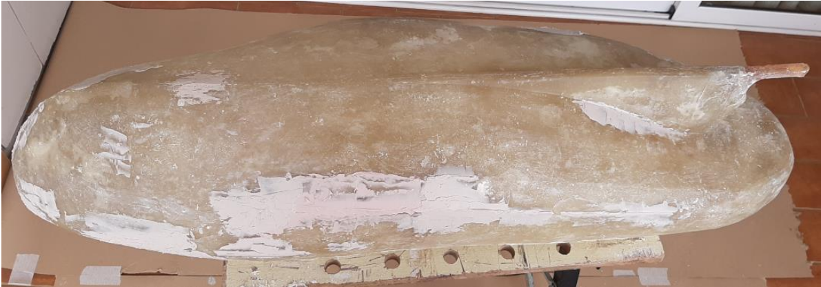
Figura 97. Arreglo imperfecciones (Fuente: Propia)
