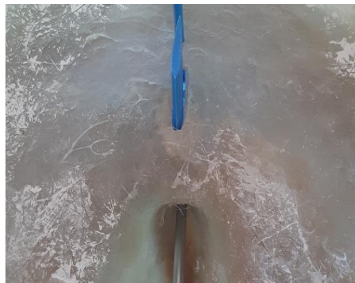
Figura 98. Agujeros timón, bocina y conducto (Fuente: Propia)
