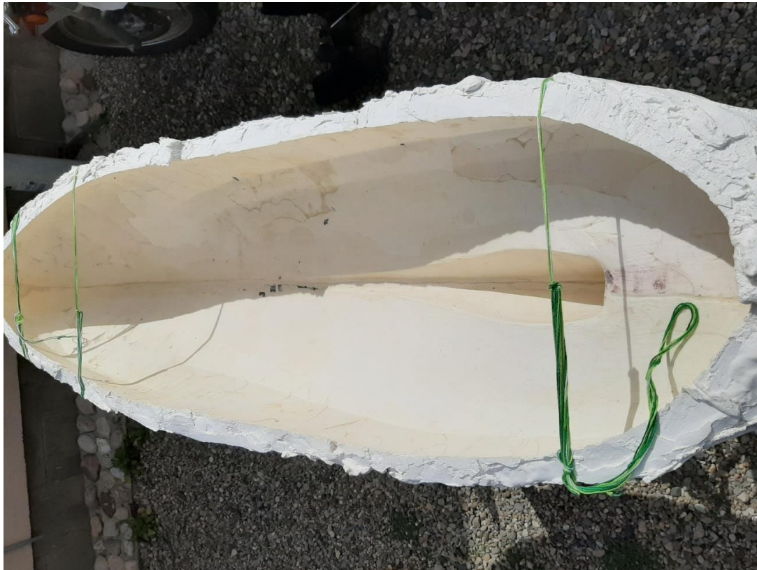
Figura 88. Molde preparado para enfibrado (Fuente: Propia)
