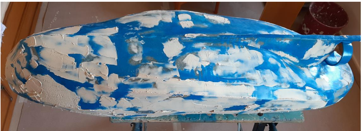
Figura 100. Masillado (Fuente: Propia)
