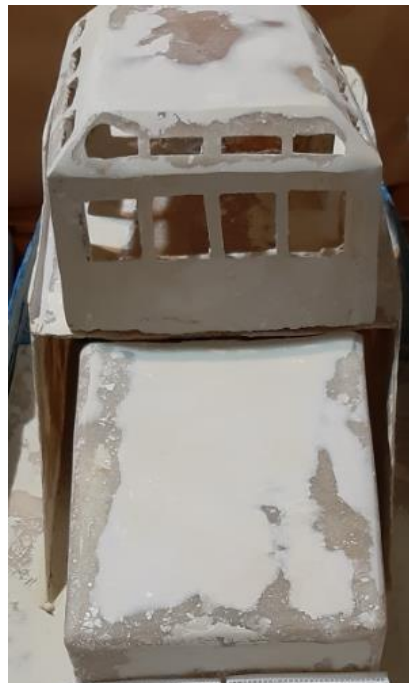
Figura 119. Cabina y soportes masillados y pulidos (Fuente: Propia)
