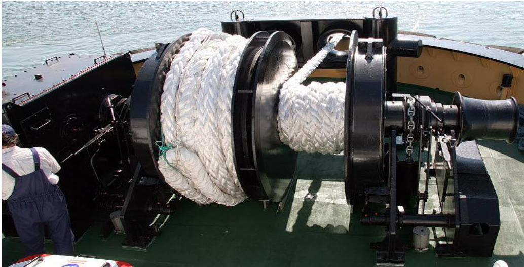
Figura 16. Chigre de remolque [15]
