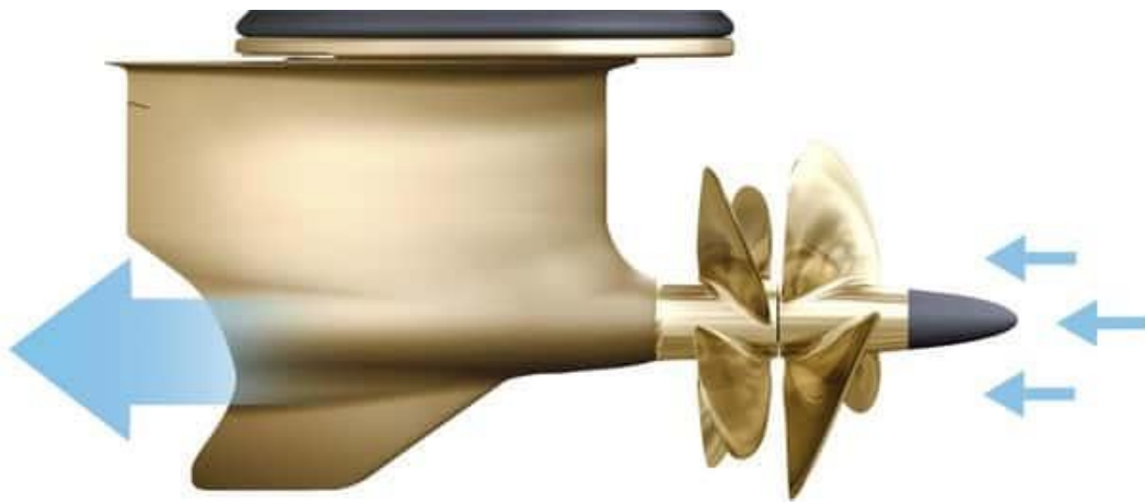
Ilustración 18. Hélices contrarrotantes orientadas a proa. Fuente: Página web de Volvo Penta, Sistema IPS [12] .
