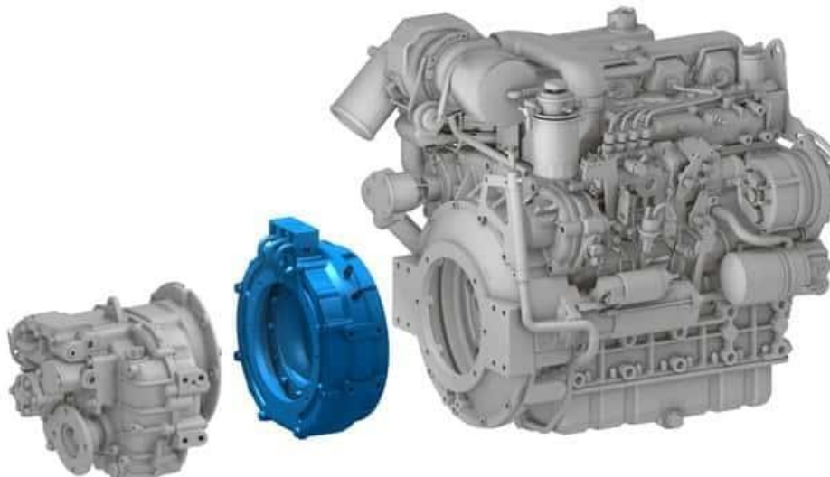
Ilustración 20. Sistema de propulsión híbrido en paralelo. Fuente: Página web de Náutica y Yates [15] .
