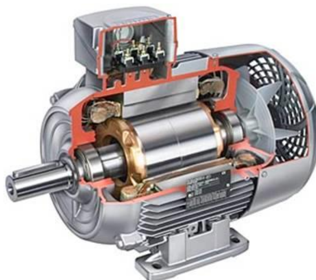
Ilustración 23. Motor síncrono de imán permanente. Fuente: Página web de monografías [18] .
