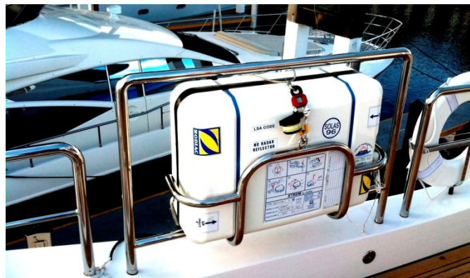
Figura 48. Ejemplo de la colocación de una balsa salvavidas en cubierta. Fuente: NauticExpo
