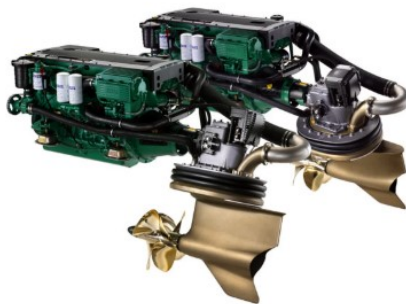
Figura 13. Sistema POD. Fuente: Volvo Penta
