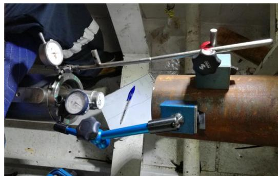
Imagen 34. Alineación radial y angular.
