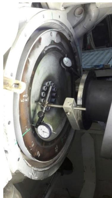
Imagen 44. Posición del reloj comparador para alinear de forma angular.
