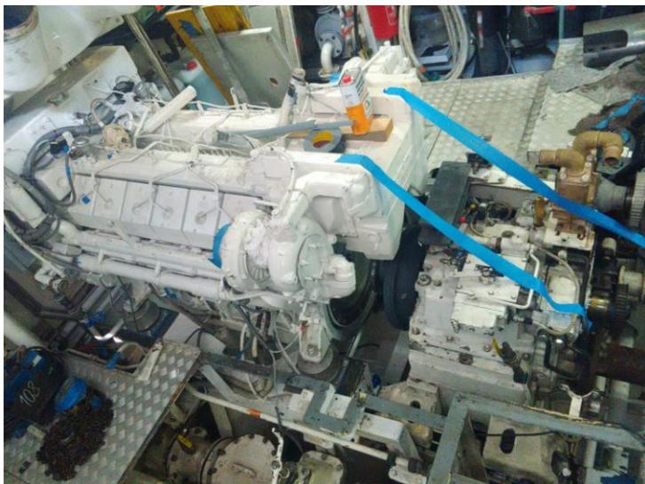
Imagen 43. Vista de motor y reductora ya alineado.
