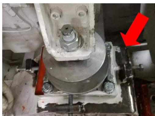
Imagen 11. Contretes de empuje de la reductora. Imagen 10. Contretes de empuje del motor.
