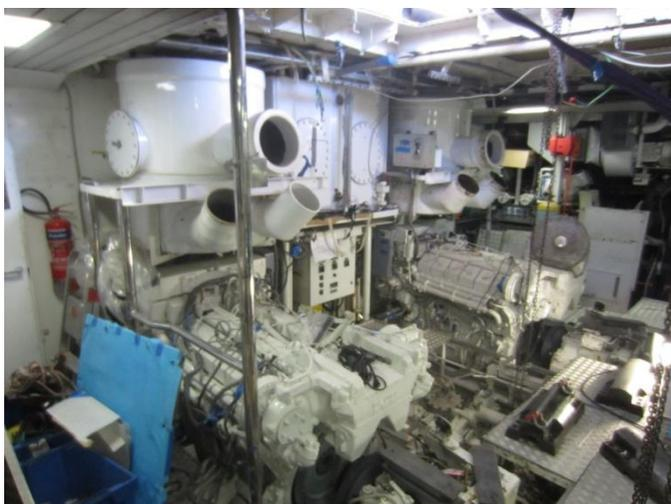
**Imagen 29. Vista de los motores principales y sus silenciadores.**
