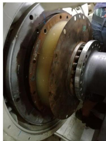
Imagen 40. Vista del acoplamiento a punto de ser montado.
