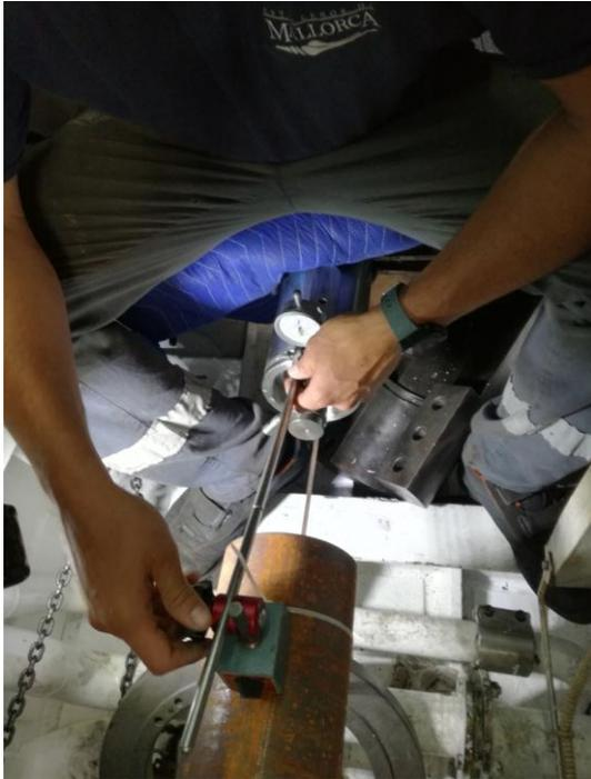
Imagen 31. Alineación de la reductora con el carrete.
