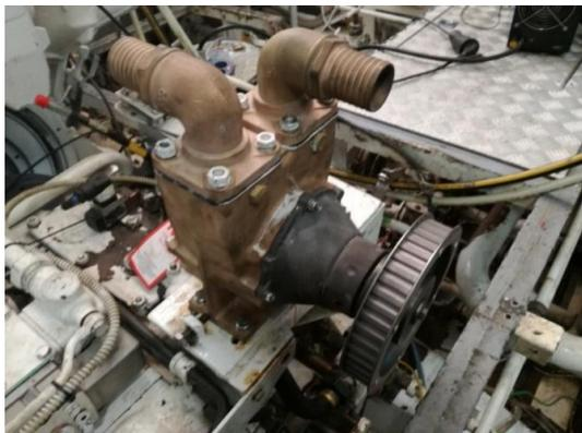
**Imagen 27. Bomba de agua de la reductora.**
