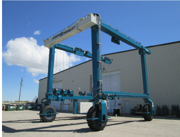
Imagen 20: Ejemplo de un travelift para extraer embarcaciones del agua.
