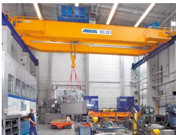
Imagen 11: Ejemplo de puente grúa birraíl ABUS ZLK .
