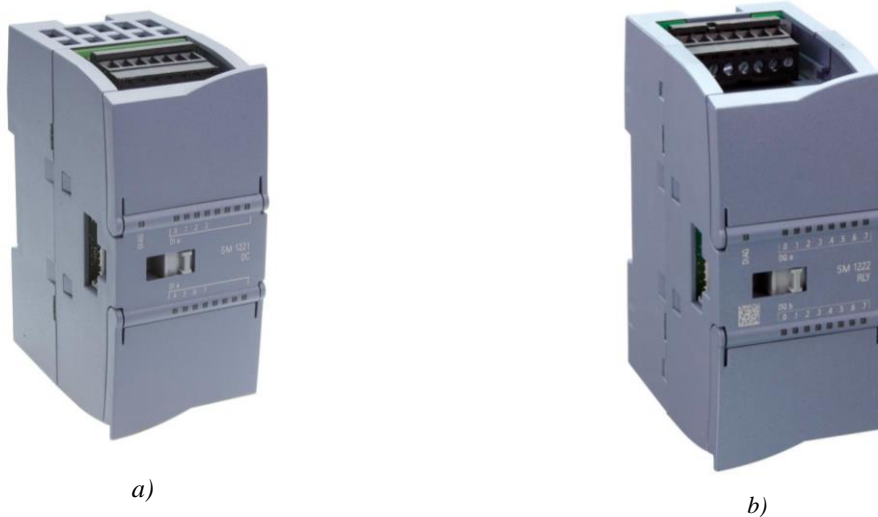
Fig. 8.8.- a) Siemens SM 1223 DC/RLY - 6ES7223-1PH32-0XB0 (8 DI/8 DO). b) Siemens SM 1222 - 6ES7222-1HH32-0XB0 (16DO). Source [44].
