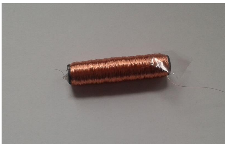
Figura 5.4.- Primer prototip d'electroimant.
