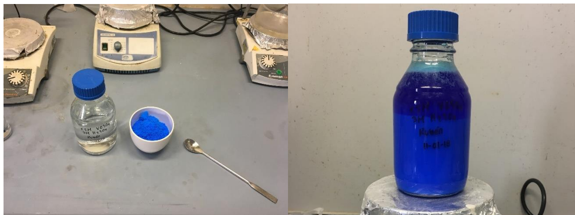
Figura 15: Preparación del electrolito de la batería.
