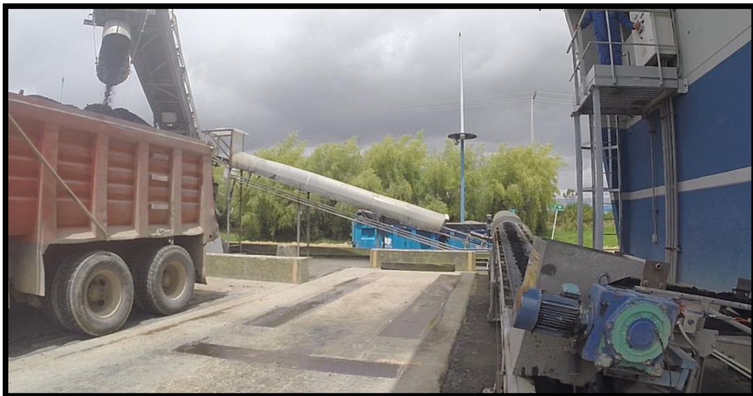
Figura 4.11 Deshidratación del fango por filtro de bandas. Fuente: Fotografía de elaboración propia.
