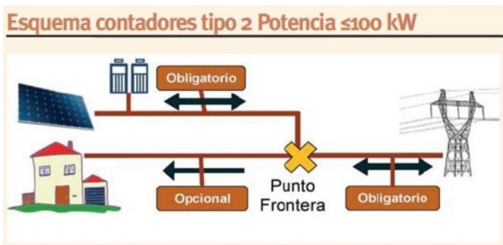
Figura 4.7. Esquema de contadores requeridos para la modalidad de autoconsumo tipo 2 para titulares únicos con instalaciones P \leq 100 kW
