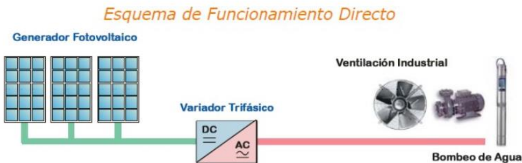
Figura 3.11. Esquema de funcionamiento directo
