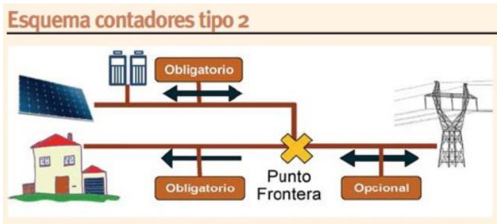
Figura 4.6. Esquema de contadores requeridos para la modalidad de autoconsumo tipo 2
