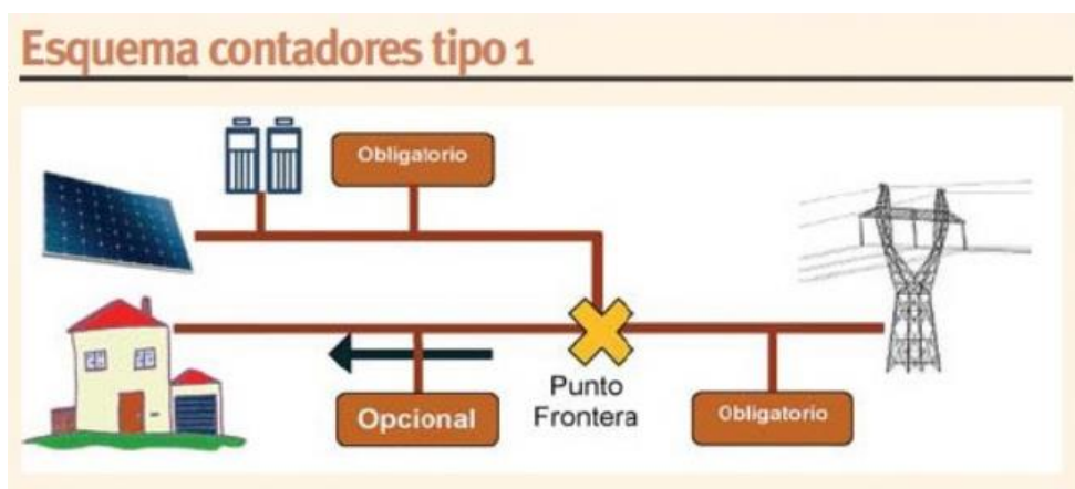
Figura 4.5. Esquema de contadores requeridos para la modalidad de autoconsumo tipo 1
