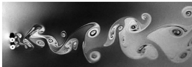
Figura 2. Calle de Von Karman compleja debido a la posición de dos cilindros paralelos. (Imagen extraída de la página web de la NASA y GES DISC).
