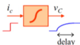
Fig 6.3: Acció integral representada per un bloc integral i un retard (Font [20]).
