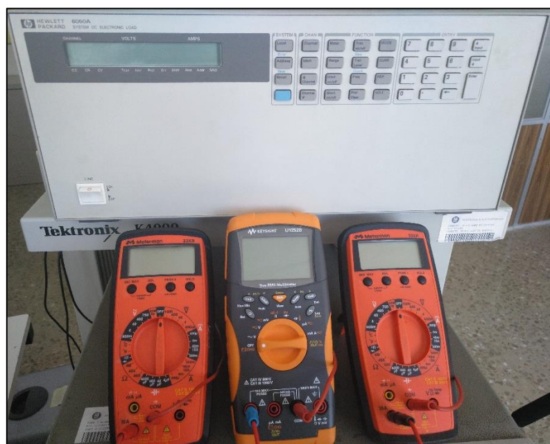
Figura 4.18 – Càrrega electrònica i multímetres
