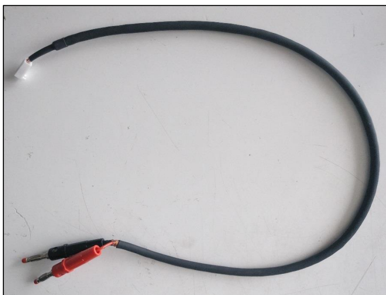
Figura 4.8 – Cables d'alimentació de les plaques
