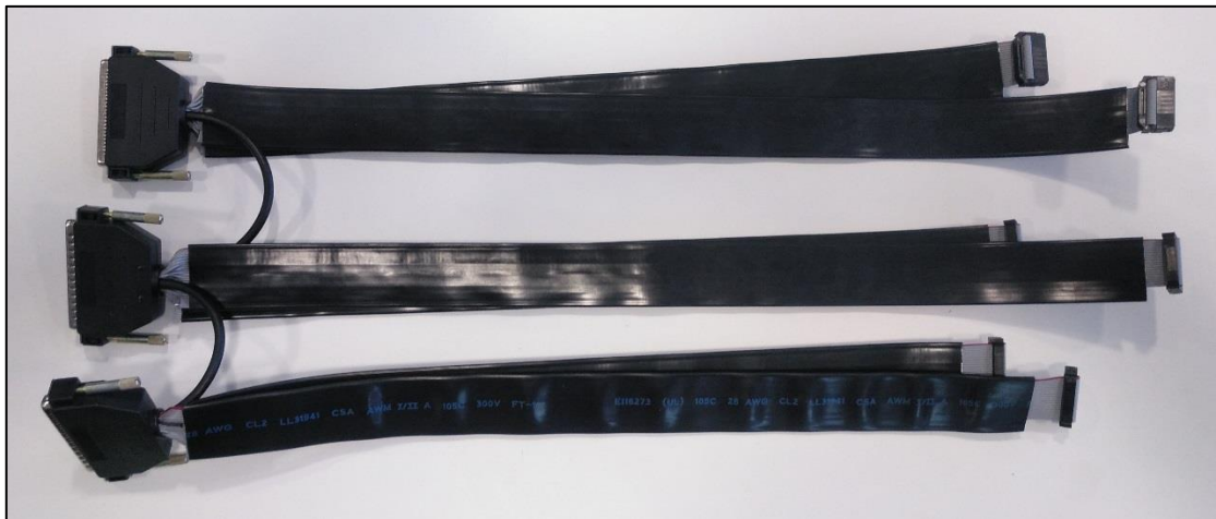
Figura 4.4 – Cables pels senyals de control acabats
