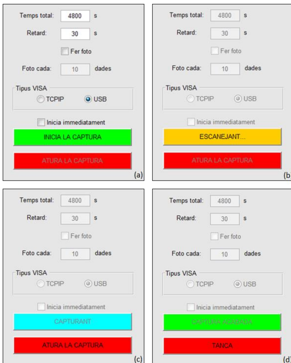
Figura 3.4 – Panell de control en diferents estats de la captura: (a) Inici del programa. (b) Buscant l’arxiu temporal. (c) Capturant dades de l’oscil·loscopi. (d) Amb la captura finalitzada
