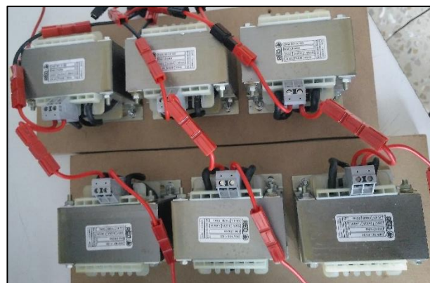
Figura A.5 – Bobines de la càrrega trifàsica
