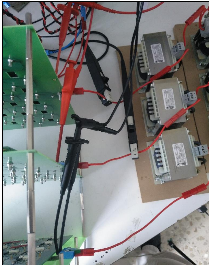
Figura A.21 – Connexió Aron al costat d'alterna del convertidor
