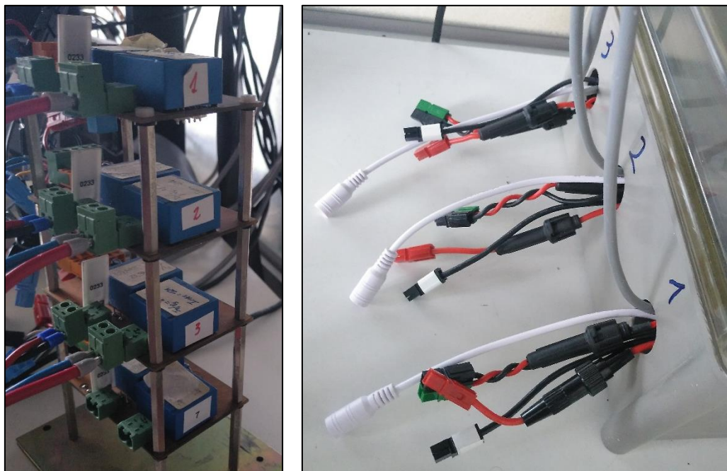
Figura A.19 – Numeració de les bateries i els sensors per connectar-los correctament
