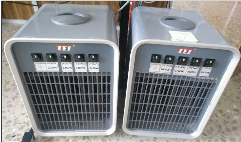
Figura A.6 – Resistències (estufes) de la càrrega trifàsica
