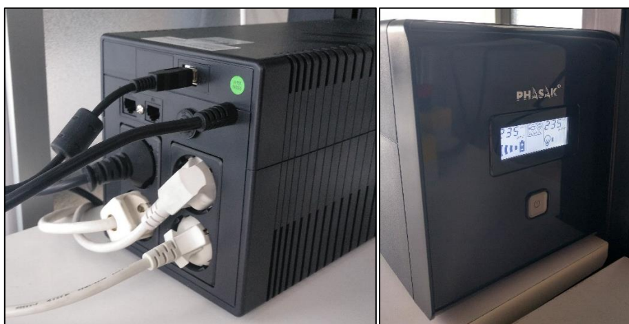
Figura A.11 – Sistema d'Alimentació Ininterrompuda (frontal i posterior)
