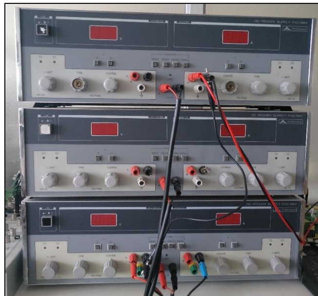
Figura A.7 – Fonts de CC usades per alimentar el convertidor i els sensors
