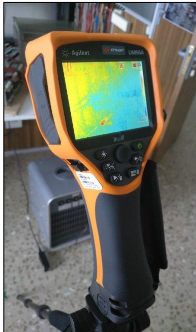
Figura A.4 – Càmera tèrmica Keysight U5855A: detall (esquerra) i col·locació al trípede (dreta)
