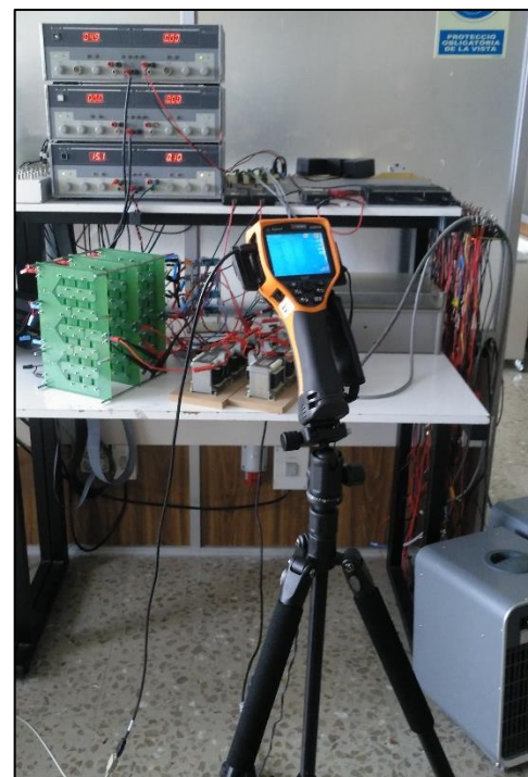
Figura A.22 – Fotografies del sistema durant una prova de calibratge (esquerra) i del convertidor (dreta) amb els objectes mòbils en primer pla, la torre de fonts i la càmera en el trípede respectivament
