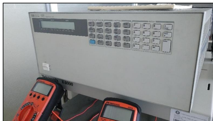
Figura A.8 – Càrrega electrònica i multímetres usats per calibrar, i descarregar a corrent constant
