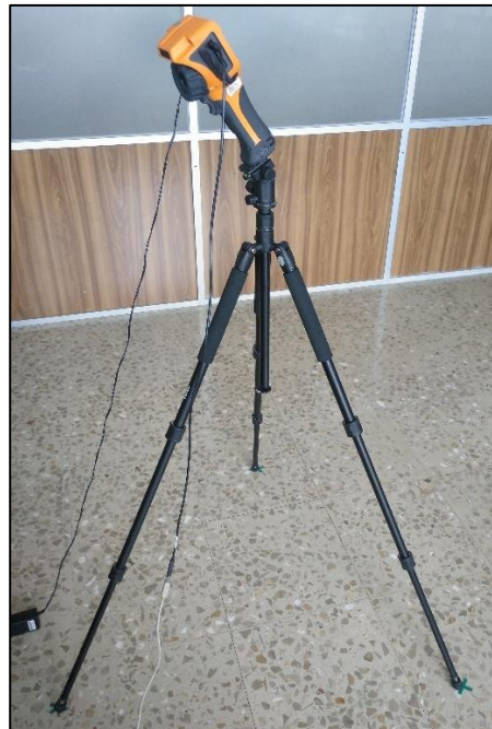
Figura A.4 – Càmera tèrmica Keysight U5855A: detall (esquerra) i col·locació al trípede (dreta)
